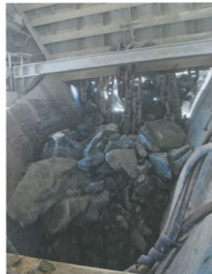
SCHWERSTARBEIT: Der intrusive Diabas hat dem mächtigen Krupp-Vorbrecher viel entgegenzusetzen.
