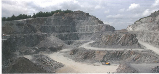
SELEKTIVE GEWINNUNG für beste Produkte: Die in Schiefer eingebetteten Diabaslagergänge sind bis zu 50 m mächtig.
