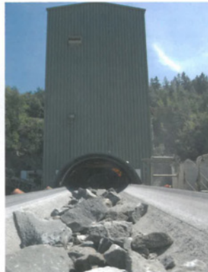
MATERIALFLUSS: Vom Vorbrecher geht es über Förderbänder weiter zum nachfolgenden Prozess.
